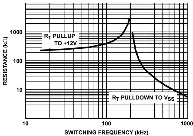
FIGURE 4. R<sub>T</sub> RESISTANCE vs FREQUENCY
