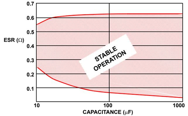
FIGURE 13. C<sub>OUT2</sub> OUTPUT CAPACITOR
