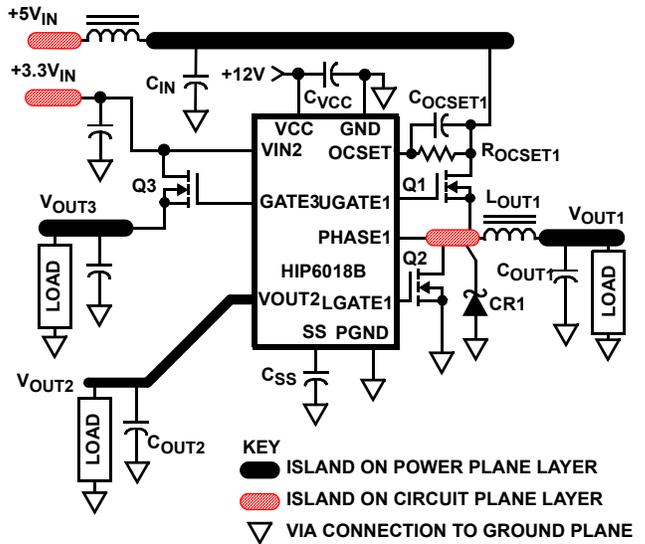
FIGURE 10. PRINTED CIRCUIT BOARD POWER PLANES AND ISLANDS
