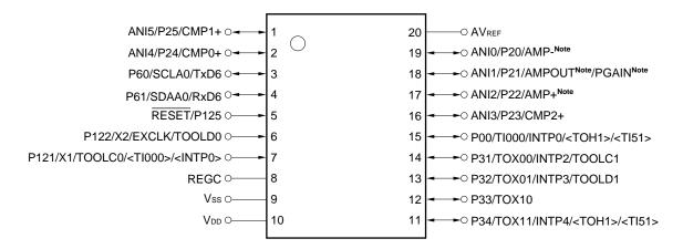
AMP-Note : Amplifier Input REGC : Regulator Capacitance
