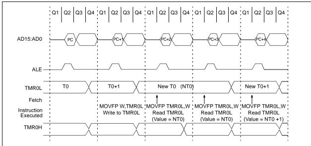
FIGURE 12-4: TMR0 READ/WRITE IN TIMER MODE
