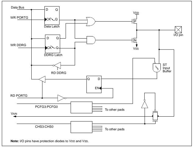
FIGURE 10-15: RG4 BLOCK DIAGRAM
